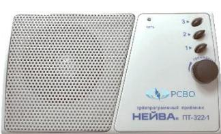
Воспроизводит три программы сети проводного вещания. Световой индикатор включения приемника, регулятор громкости и кнопки переключения программ находятся на лицевой панели прибора. Выключатель расположен на верхней крышке приемника. Регуляторы чувствительности 2-й и 3-й программы расположены на задней панели прибора.
